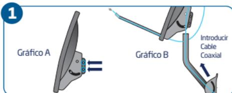
2. Coloca el plato en el mástil y orientalo hacia el Oeste (W/O), usando la brújula (ver página 5). Asegúrate de que el mástil no se mueva y asegura los pernos del gráfico A.
