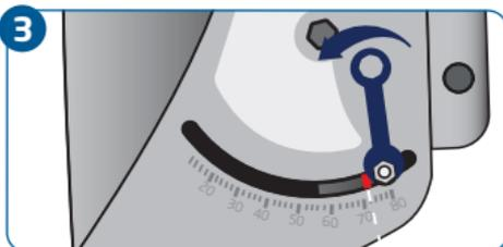
4. Inclina el plato hacia arriba o abajo, hasta que la marca roja de la escala coincida con el grado de elevación de tu ciudad.
