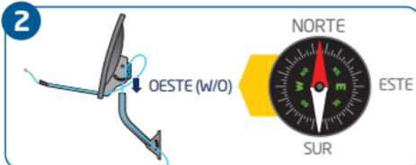
3. Realiza una curvatura con el cable coaxial como muestra la imagen, luego introduce el cable coaxial por dentro del brazo del soporte del LNB.
